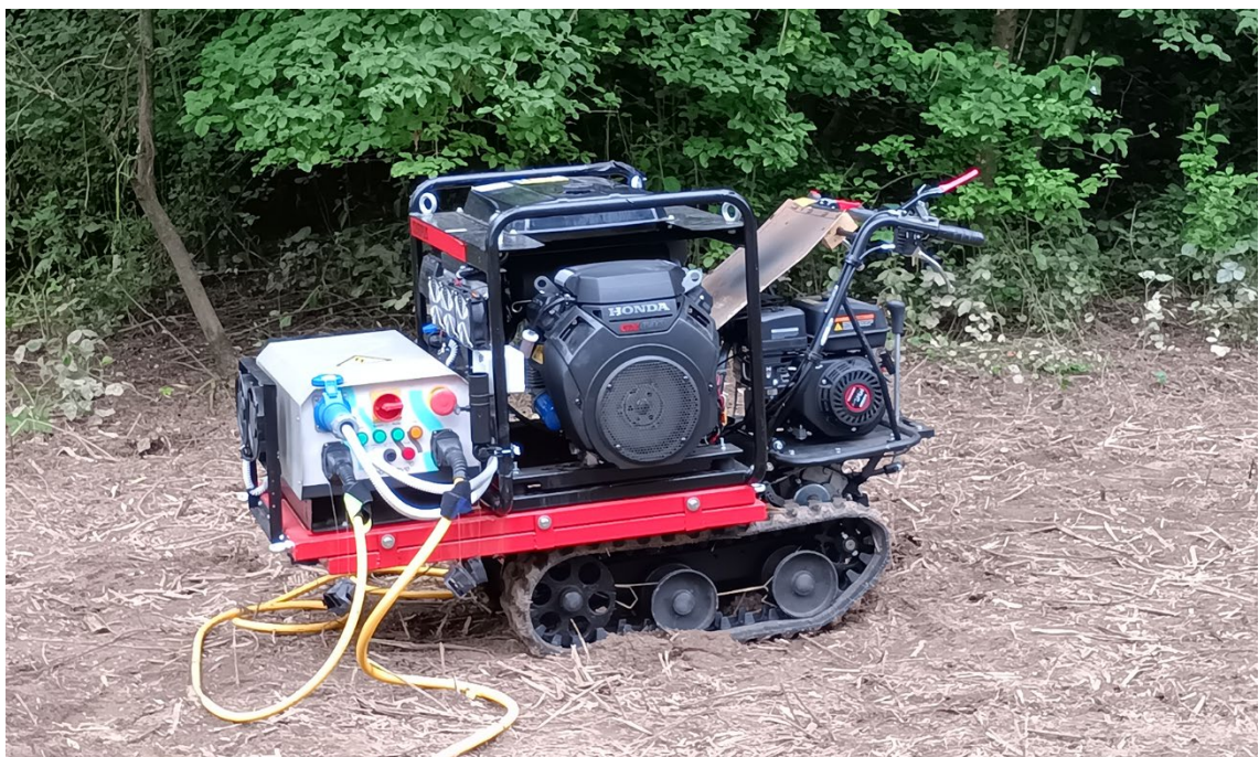
Slika 3. Naprava za zatiranje rastlin z elektriko in generator elektrike sta za dostop do delovišč naložena na samohodno samokolnico. Vir: www.odstranjevanje-invazivk.si
