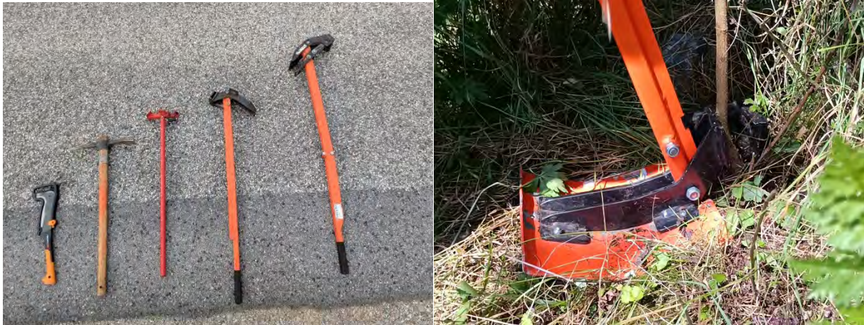
Slika 1. Orodje za ruvanje invazivnih rastlin. Foto: arhiv Zavoda Symbiosis
